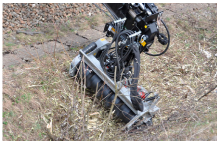
KM 931 installato su un braccio della gru montato in modo fisso (qui con una pacciamatrice)
