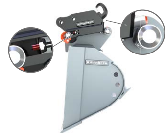
Nicht korrekt verriegelt. Riegelbolzen sind über dem zugelassenen Bereich. Anzeigestift ist ausgefahren.
